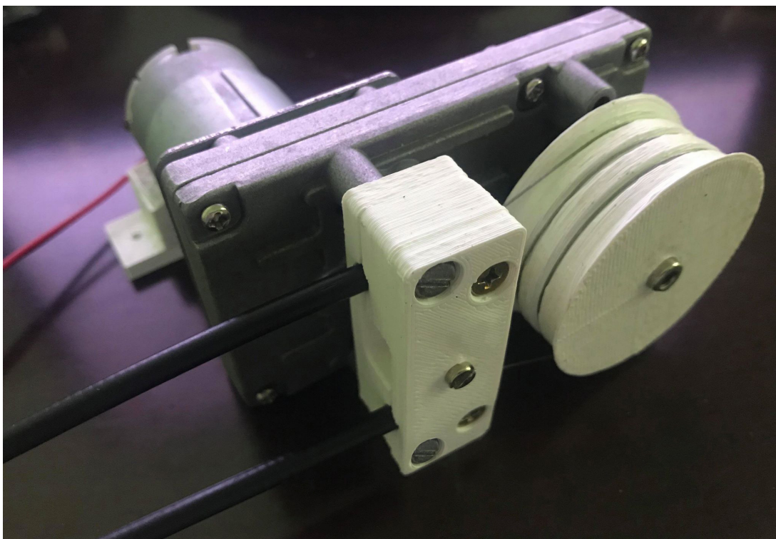
Figura 4.15 – Cabos e polia montados na caixa de redução
