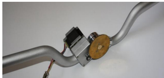
Figura 1.12 – Exoesqueleto com motor de passo como atuador
