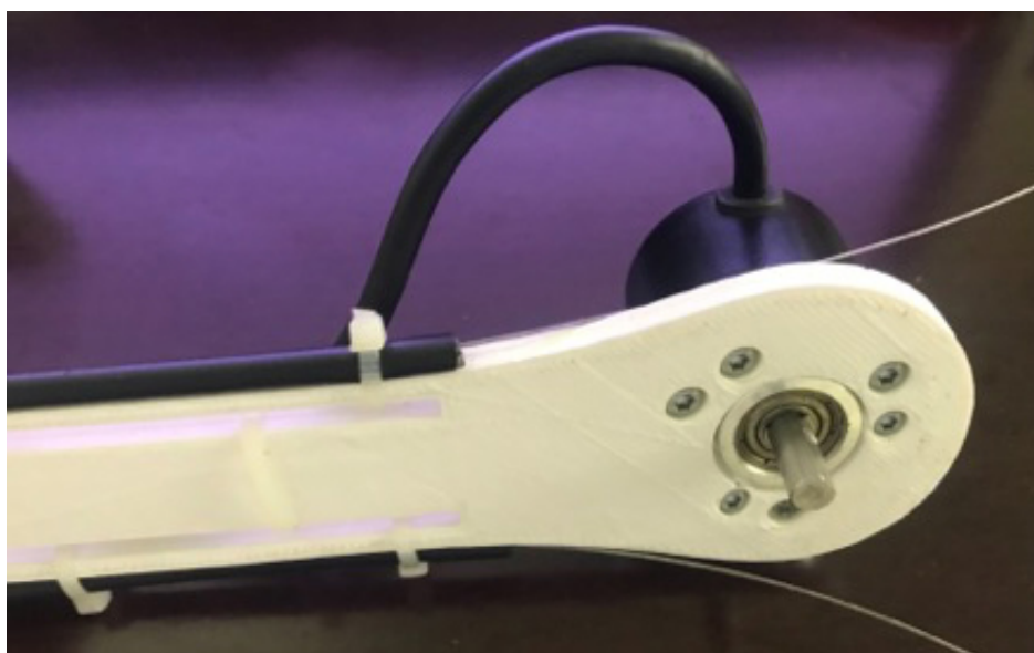
Figura 4.17 – Montagem do encoder
