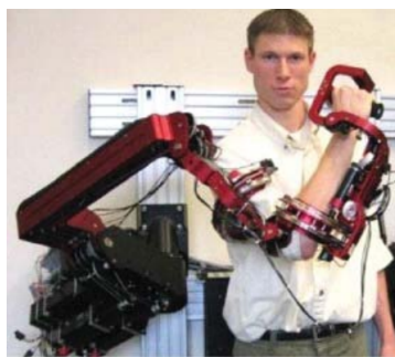
Figura 1.9 – Exoesqueleto usando cabos para transmitir potência
