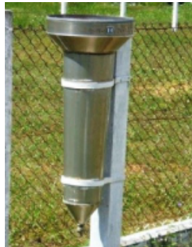
Figura 2.5 – Pluviômetro “ Ville de Paris ”.
