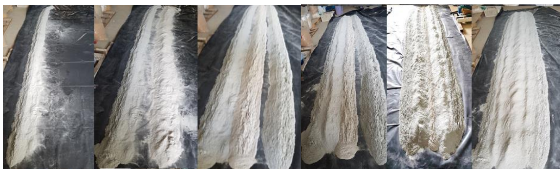
Figura 26 - Empilhamento tipo windrow para homogeneização do calcário Fonte: Autoria própria.
