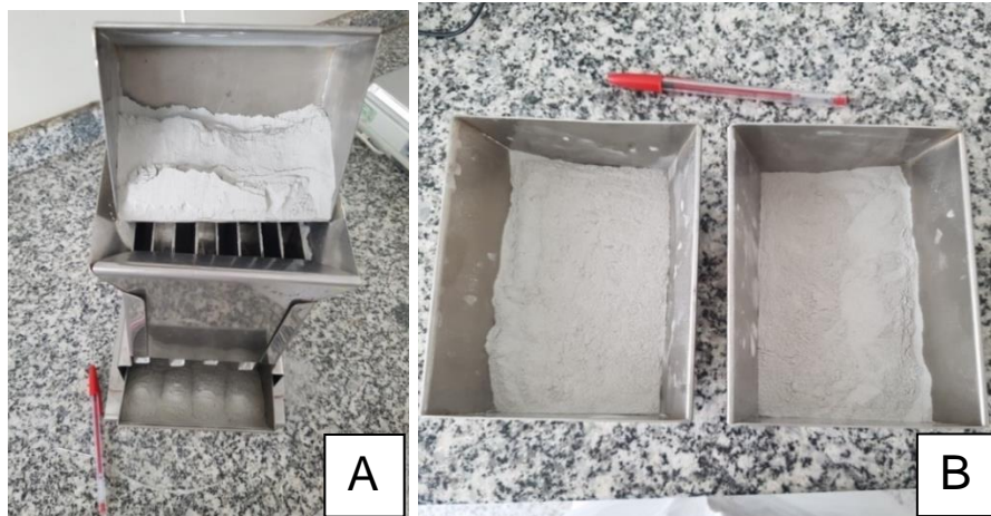
Figura 27 - A) Quarteamento da matéria prima B) Amostra quarteada Fonte: Autoria própria.
