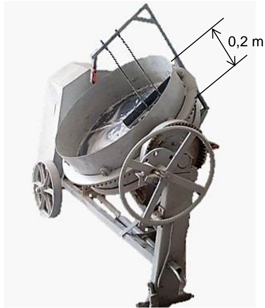
Figura 19 - Pelotizador desenvolvido (vista lateral) Fonte: Autoria própria.
