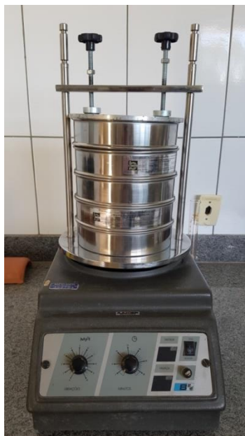
Figura 31 – Agitador de peneiras utilizado na classificação granulométrica do produto Fonte: Autoria própria.
