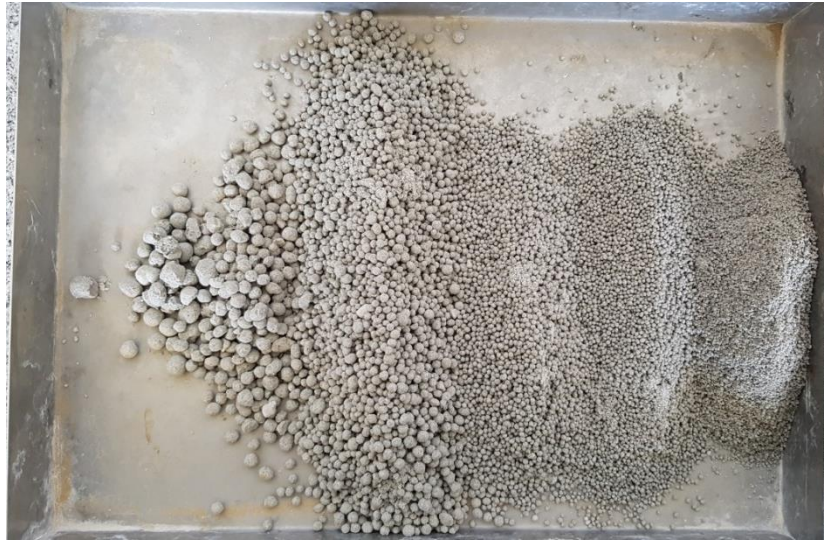
Figura 60 - Distribuição granulométrica do produto pequeno Fonte: Autoria própria.
