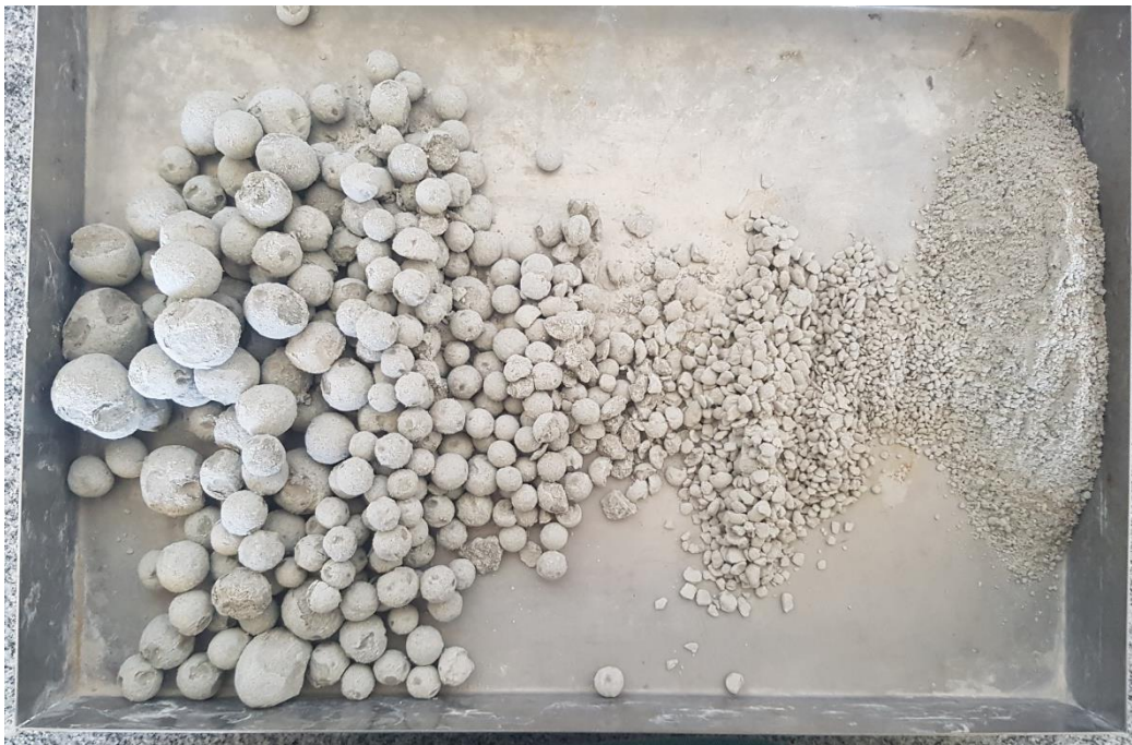
Figura 66 - Distribuição granulométrica do produto grande Fonte: Autoria própria.
