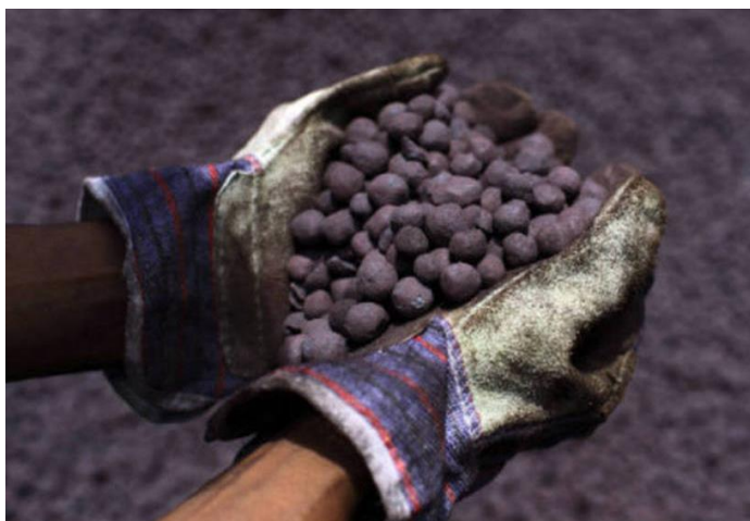
Figura 3 - Pelotas de minério de ferro Fonte: Exame (2018).
