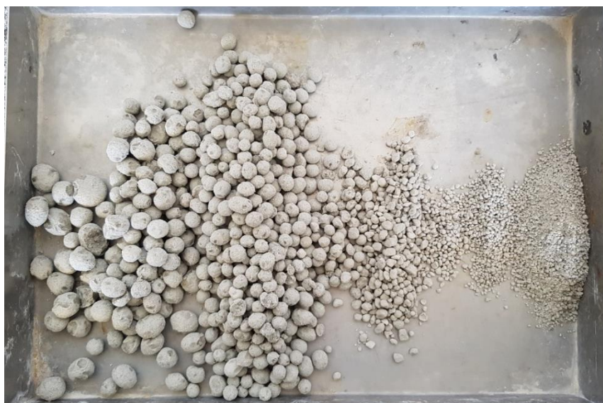
Figura 63 - Distribuição granulométrica do produto médio Fonte: Autoria própria.
