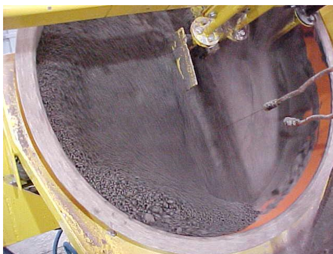
Figura 10 - Pelotização de calcário em disco Fonte: Veverka e Hinkle (2001).
