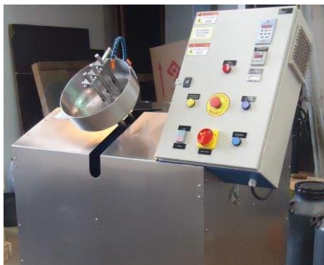
Figura 8 - Disco de pelotização em escala laboratorial Fonte: Brastorno, 2017.
