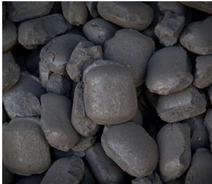
Figura 2 - Briquetes de minério de ferro Fonte: Portal Fator Brasil (2011).
