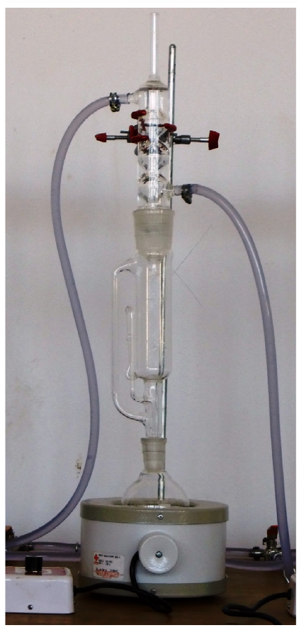
Figura 26 – Conjunto usado na extração, formado pelo extrator Soxhlet, condensador e manta aquecedora
