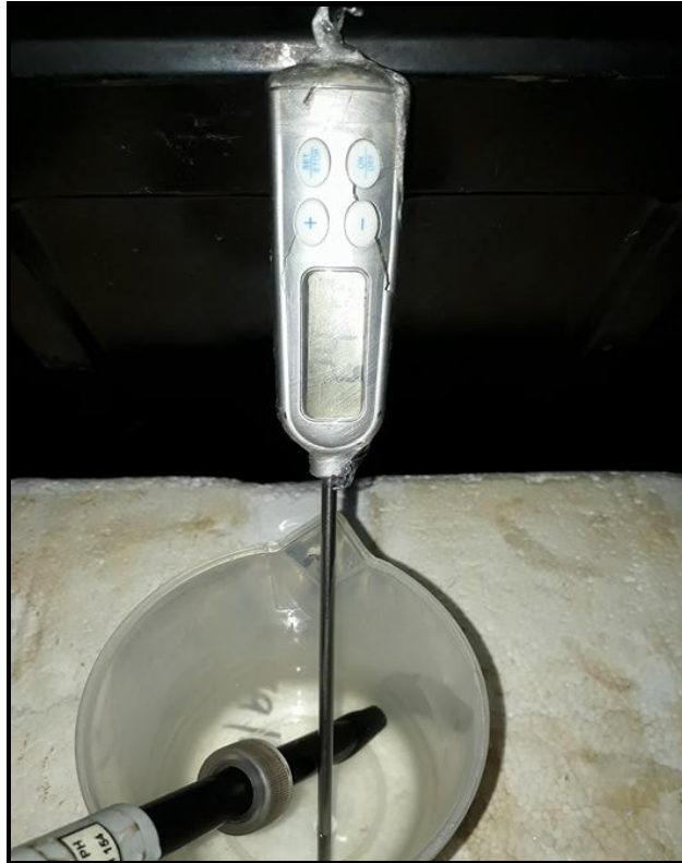
Foto 10 - Termômetro e Pehgâmetro, aparelhos utilizados na coleta de amostras de efluentes
