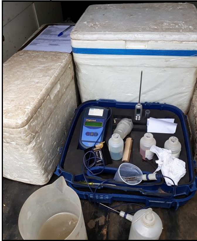
Foto 4 - Materiais e equipamentos utilizados na coleta de amostras. Caixas térmicas, álcool, borrifador, jarras, ficha de coleta e termômetro
