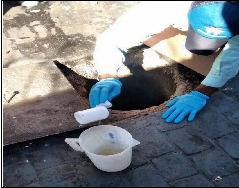
Foto 5 - Demonstração do uso de EPIs no ato da coleta de amostras
