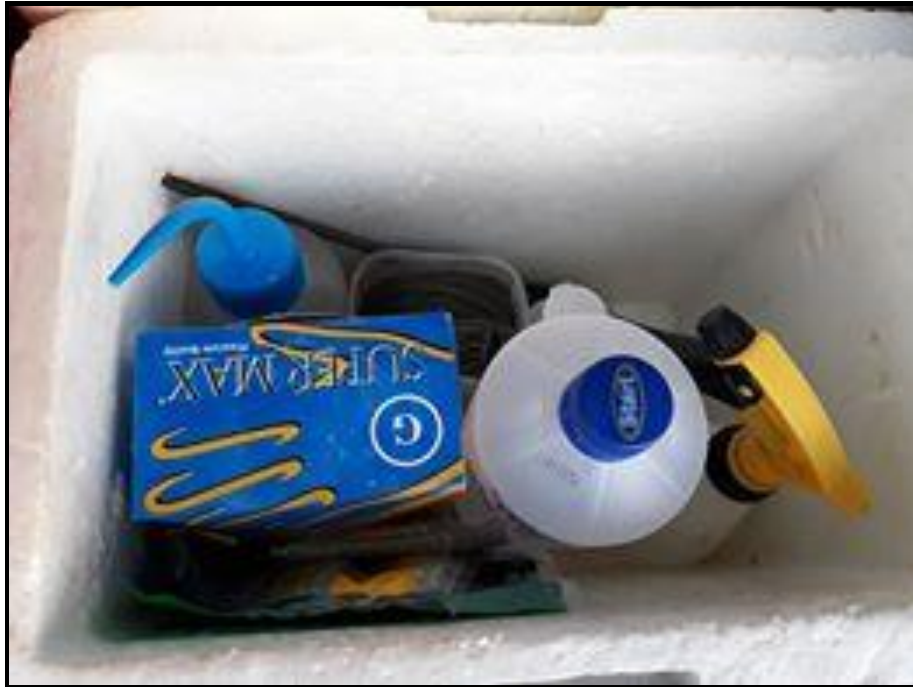
Foto 1 - Material usado na coleta de amostras de efluentes
