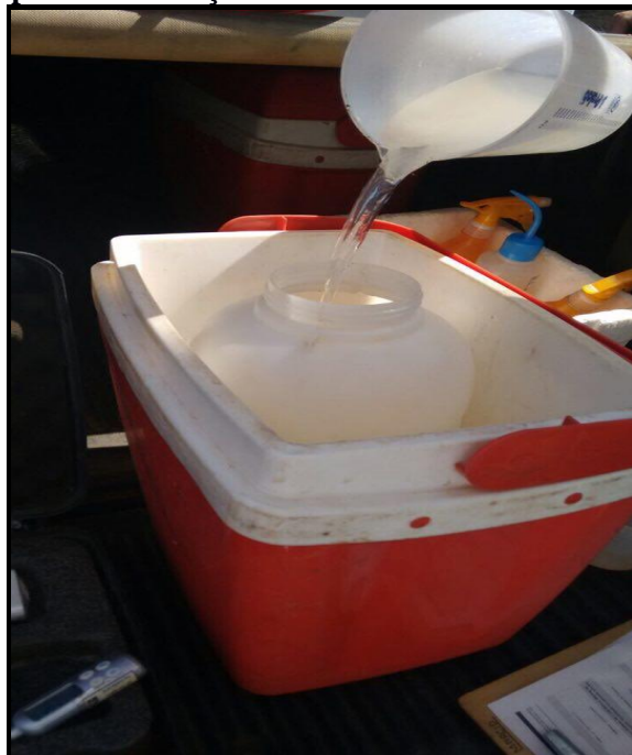
Foto 11 - Amostras de efluentes sendo armazenadas em bombonas (frasco maior) para conservação até o termino da coleta
