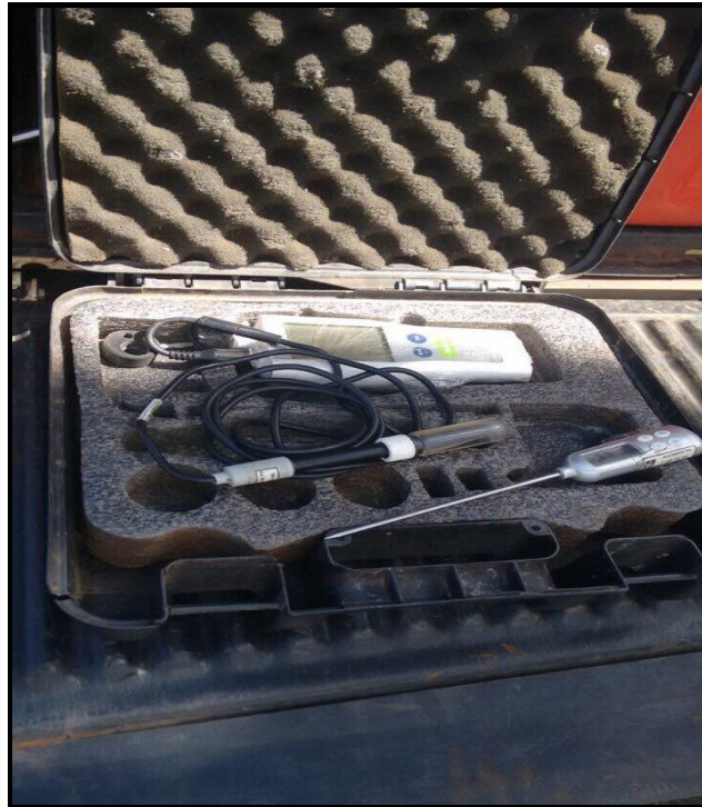
Foto 9 – Caixa com Termômetro e Pehgâmetro, aparelhos utilizados na coleta de amostras de efluentes
