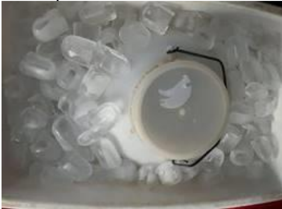
Foto 12 - Amostras de efluentes armazenadas para serem levadas ao Laboratório para análises
