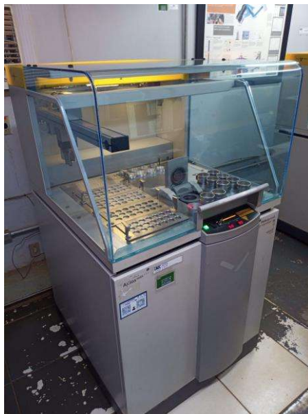
Figura 17 - Equipamento de Fluorescência de raio X Axios da marca Panalytical
