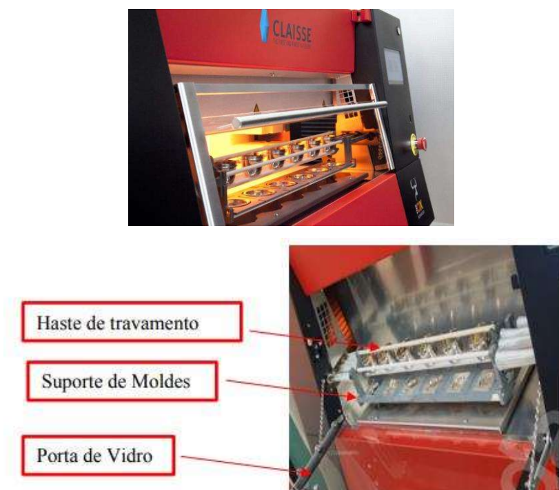
Figura 15 - Máquina de fusão elétrica em operação (TheOx) (Imagem Superior) / Elementos da máquina de fusão elétrica (TheOx) (Imagem Inferior)
