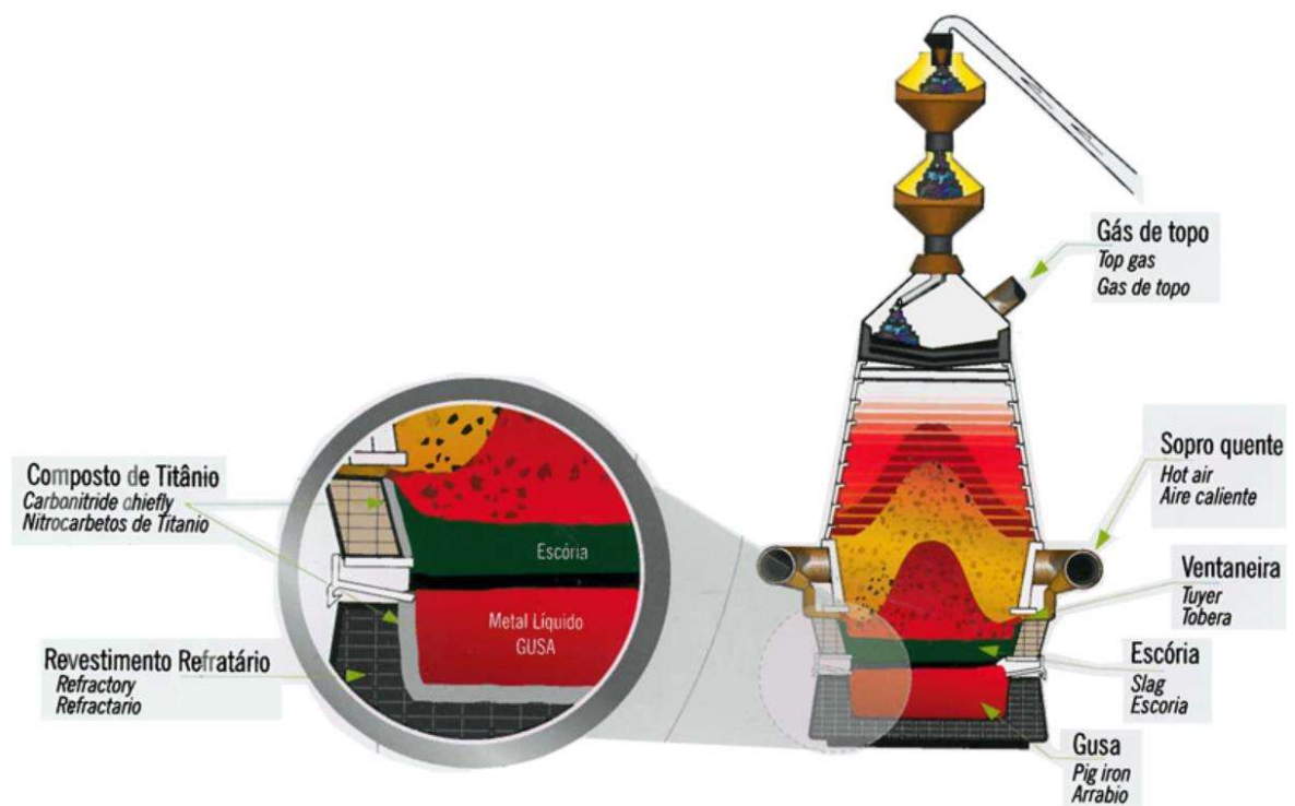
Figura 11 - Desenho de alto forno e área de aplicação de concentrado de titânio
