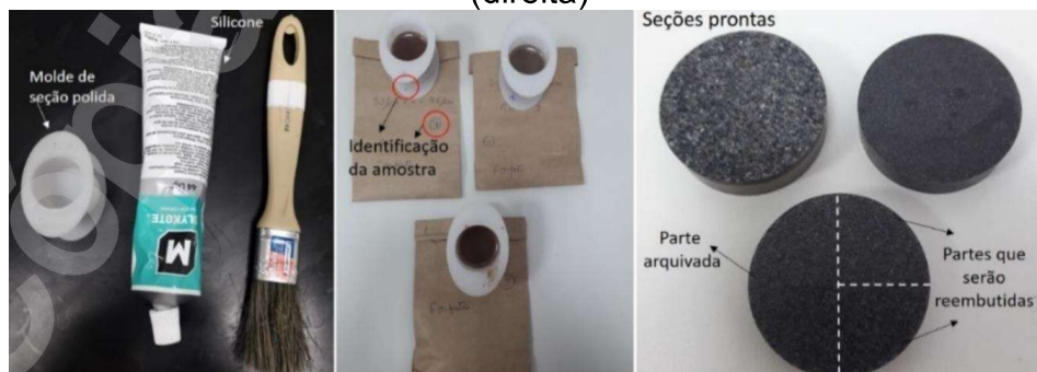
Figura 21 - Molde de seção polida e silicone para revestimento de molde (esquerda). Moldes com amostras posicionadas (centro). Seções polidas prontas (direita)
