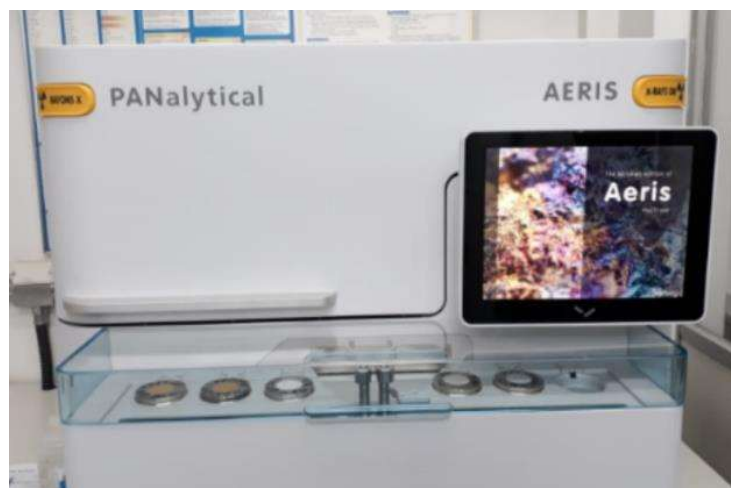
Figura 18 - Difratômetro de raios-X de bancada AERIS Minerals da Panalytica
