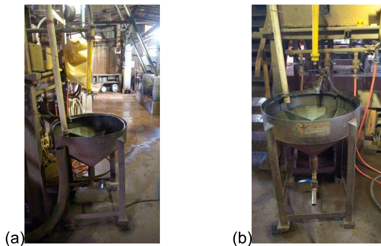
Figura 24 - Deslamagem laboratorial utilizada para os ensaios (a)lateral (b)frente
