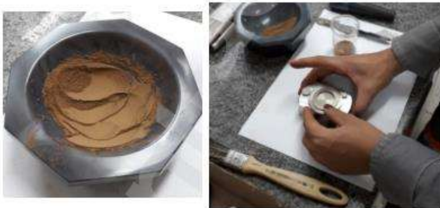
Figura 19 - Amostra moída com utilização de pistilo & posicionamento do material no aro de pastilha
