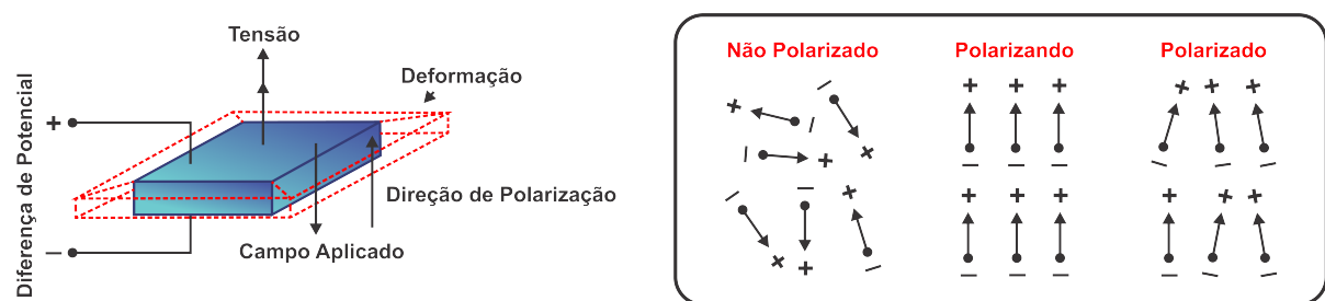
Figura 2.1 – Relações dos eixos de coordenadas do efeito piezoelétrico e do processo de polarização.
