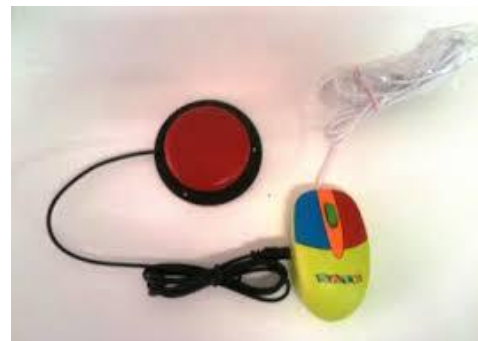
Fig. 06. Mouse adaptado com acionador.
