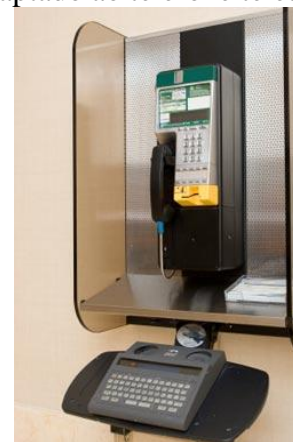
Fig. 04. Telefone público adaptado ao telefone teletipo.
