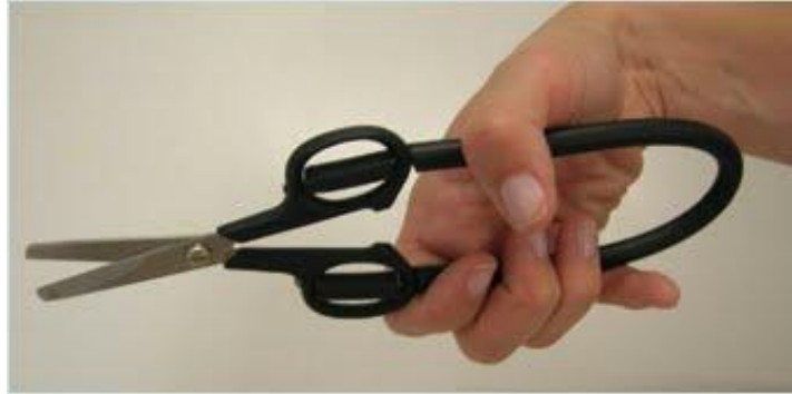
Fig. 24. Tesoura adaptada com arame revestido.
