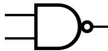
Figura 3.9: Porta lógica NAND, Por jjbeard (feito no Inkscape 0.43) [Domínio Público], via Wikimedia Commons
