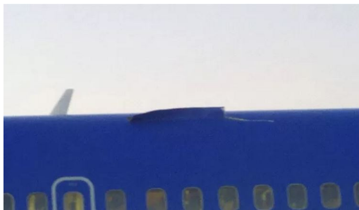
Figura 1.1 – Fissura aberta na parte superior da aeronave Boeing 737-300 (Foto: Don Nelson / AP).
