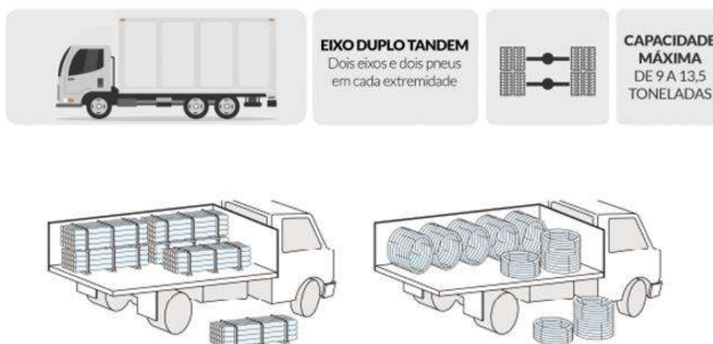
Figura 19 – Modelo de veículo e disposição das tubulações para carga.
