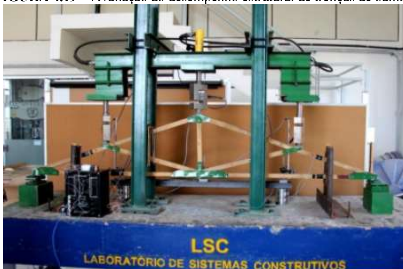
FIGURA 4.19 – Avaliação do desempenho estrutural de treliças de bambu.
