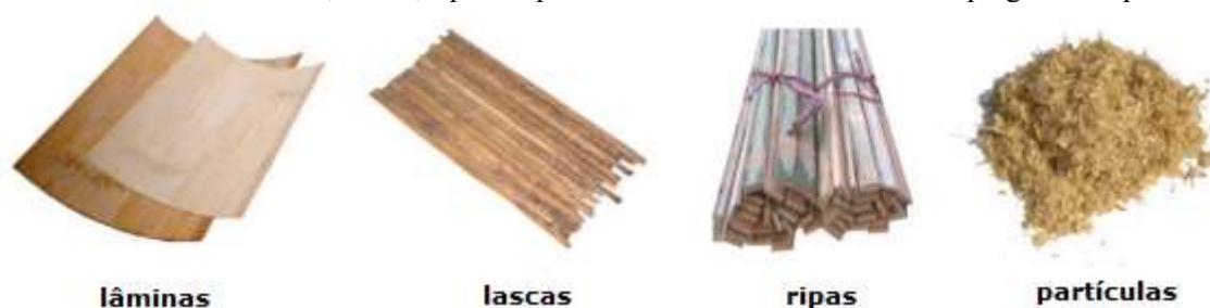
FIGURA 4.30 – Lâminas, lascas, ripas ou partículas: amostras de material empregado nos painéis.
