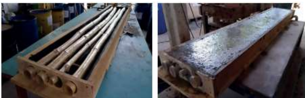
FIGURA 4.29 – Painéis modulares estruturais de bambu.
