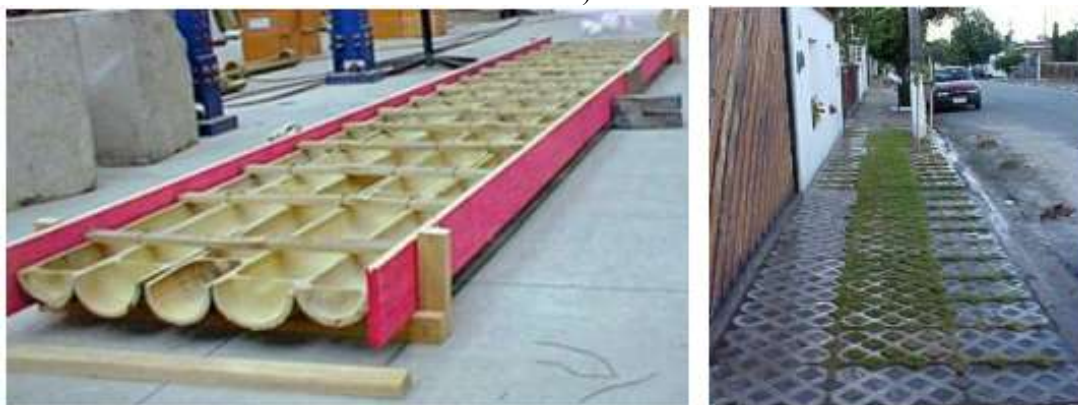
FIGURA 4.22 – Fôrma para concreto com armação em bambu (Prof. Ghavami) e Biokreto (Prof. Beraldo).
