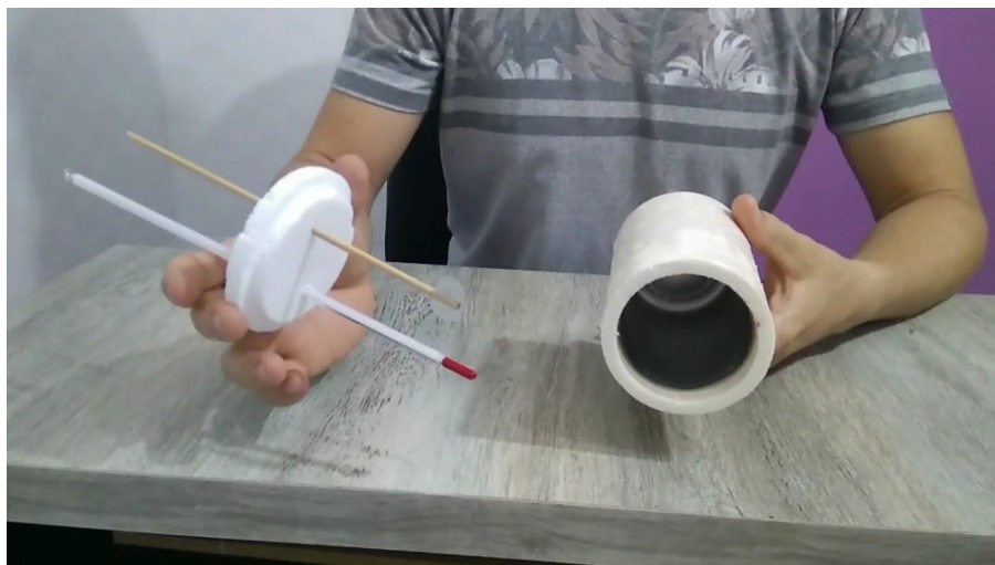
Figura 4.4 - Execução e apresentação do calorímetro caseiro
