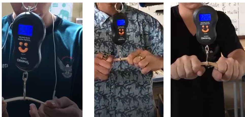
Figura 24 - Prototipagem de um ensaio de flexão em palitos e picolé
