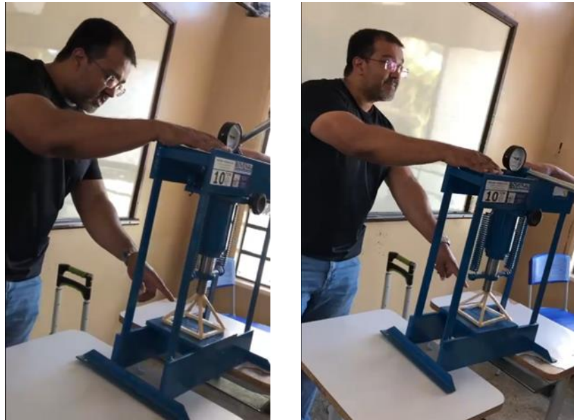
Figura 27 - Autor da dissertação testando a resistência dos protótipos de palitos de picolé
