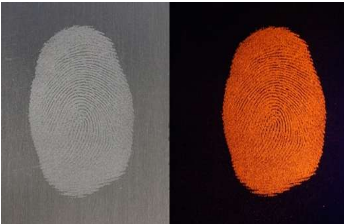
Figura 18 —Impressões digitais reveladas pelo \text{ZrO}_2\text{:Eu} sem e com aplicação de luz UV com \lambda=254\text{nm} .
