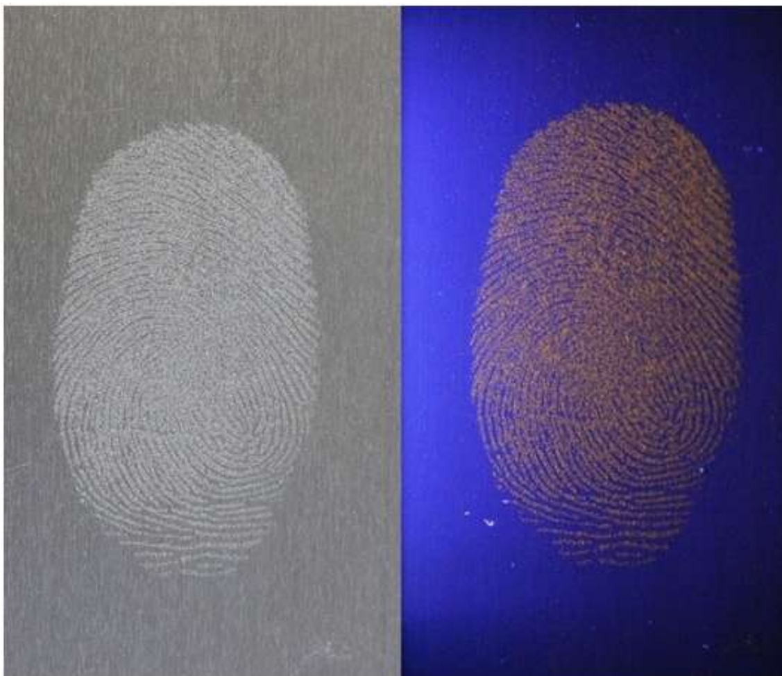
Figura 17— Impressões digitais reveladas pelo ZnO:Eu sem e com aplicação de luz UV com \lambda=254\text{nm} .
