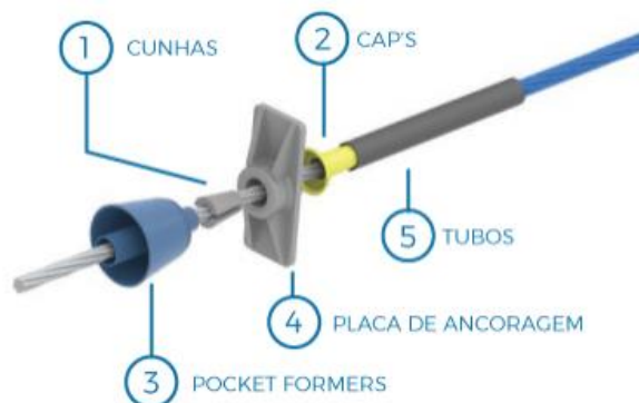
Figura 23 – Dispositivo de Ancoragem
