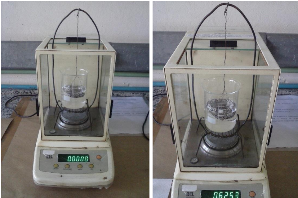
FIGURA 3.5 – Foto ilustrativa de um aparato montado em uma balança analítica, para a determinação da densidade de Arquimedes (densidade aparente).
