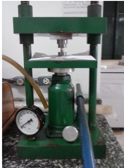
FIGURA 3.4 – Prensa e molde utilizados para a conformação do BZYO e BCGO.
