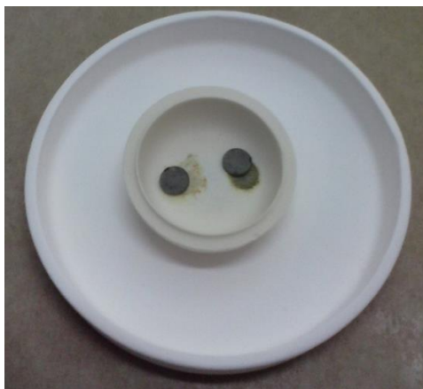
FIGURA 4.19 – Pastilhas de BCGO sinterizadas com a cama de pó e com somente a fase \text{BaCe}_{1-x}\text{Gd}_x\text{O}_{3-\delta} presente.
