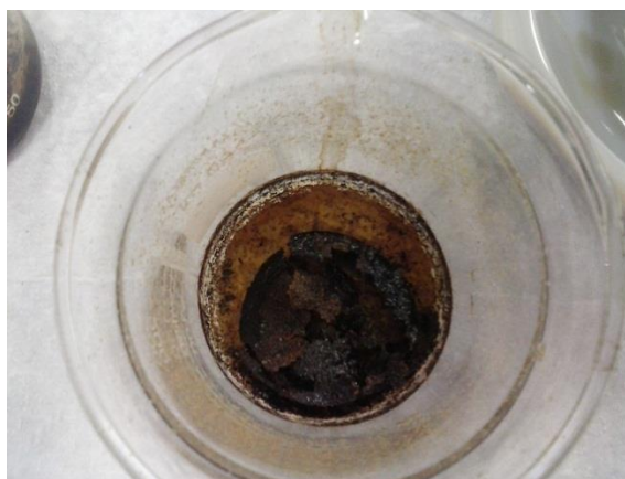
FIGURA 3.1 - “Puff” obtido a partir da síntese do BZYO.
