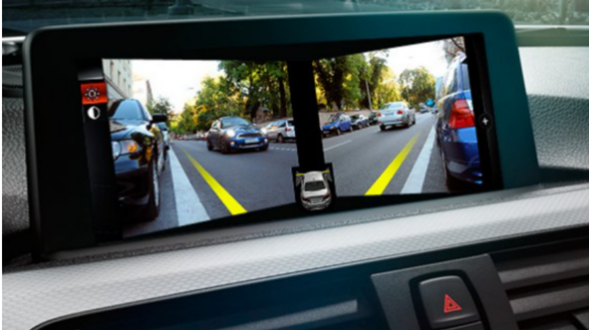
Figura 1.1 – Câmeras de vista lateral da BMW
