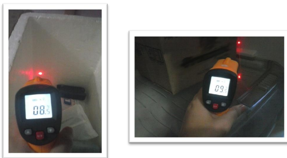
Figura 8. Aferição da temperatura média dentro da geladeira (à direita) e da caixa de isopor (à esquerda).
