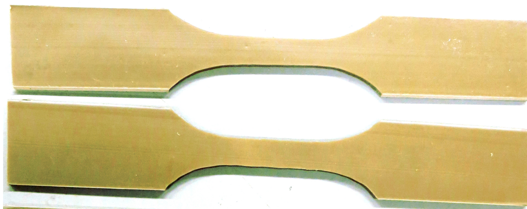
Figura 23 – Corpos de prova produzidos a partir dos tubos de 50 mm de PVC com auxílio do gabarito.
