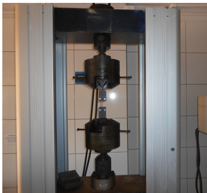
Figura 4.16 – Corpo de prova preso a máquina de tração com o auxílio do suporte.
