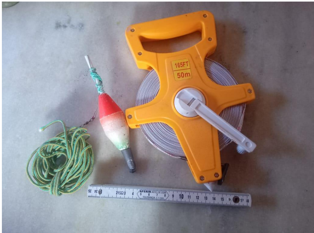
FIGURA 02: Matérias usados para medir vazão ( corda, metro sueco plástico, fita métrica longa, e boia)
