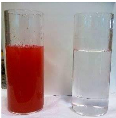
FIGURA 11 - Resíduo da indústria de tintas antes e após o tratamento por coagulação combinada à degradação eletroquímica.
