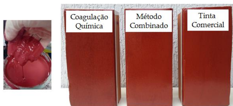
FIGURA 12: Tinta após alguns meses fechada (à esquerda), e os tijolos recobertos pela tinta produzida com água após os tratamentos e com a tinta comercial. Todos os recobrimentos foram feitos com um total de 5 demãos de tinta.
