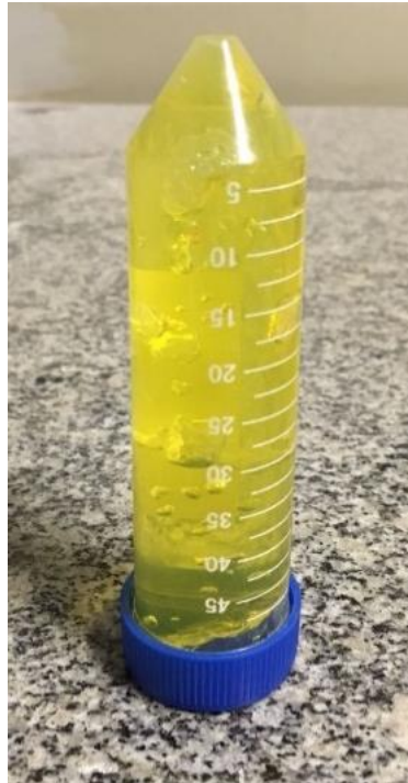
Figura 13 - Precipitado/gel amorfo de TiO 2 .
