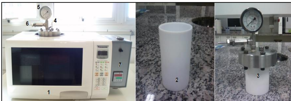
Figura 3.1.1 – Sistema hidrotérmico assistido por micro-ondas: 1. forno de micro-ondas adaptado; 2. copo coletor de teflon; 3. reator de teflon; 4. Termopar; 5. Manômetro; 6. válvula de segurança; 7. Controlador.
