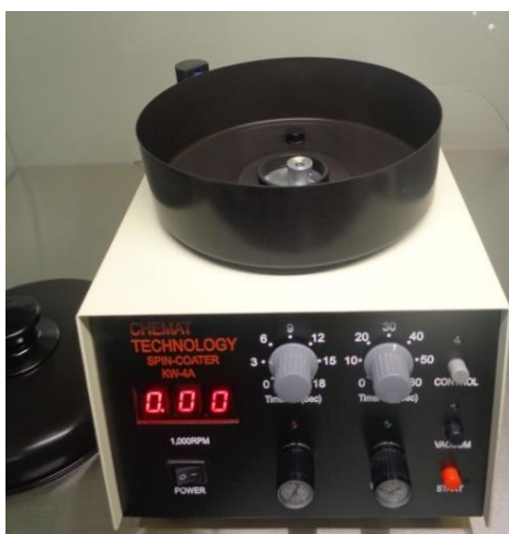
FIGURA 3.6: Dispositivo Spin Coater utilizado para deposição dos filmes de ZrO_2 sobre a superfície dos eletrodos de DSA ® .
