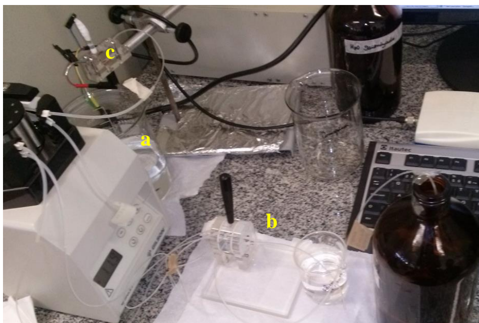
FIGURA 3.9: Esquema ilustrativo do sistema utilizado nas análises por injeção em fluxo: a) Bomba peristáltica; b) Injetor-comutador e c) Detector.
