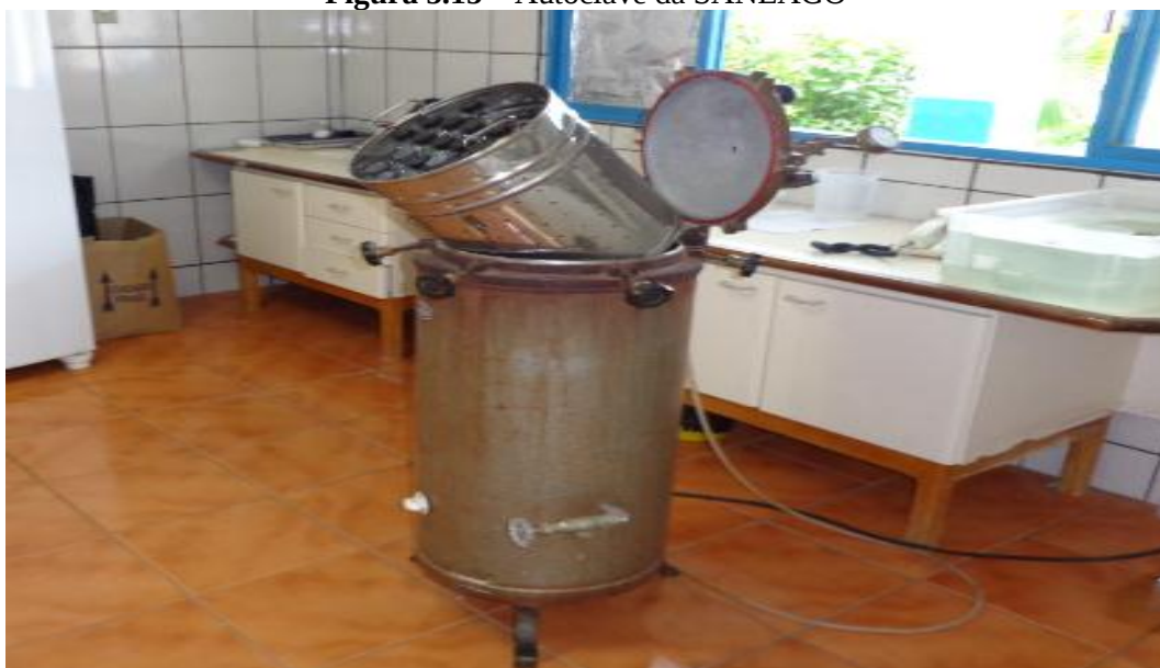
Figura 5.15 – Autoclave da SANEAGO
