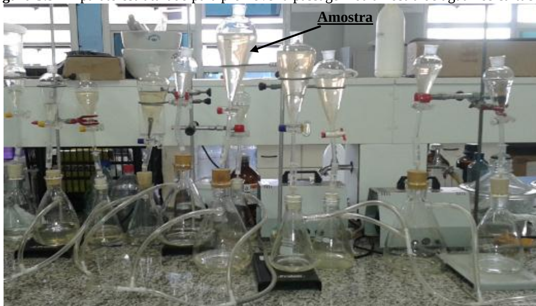
Figura 5.9 – Aparato estruturado para promover a passagem da amostra de água nos cartuchos
