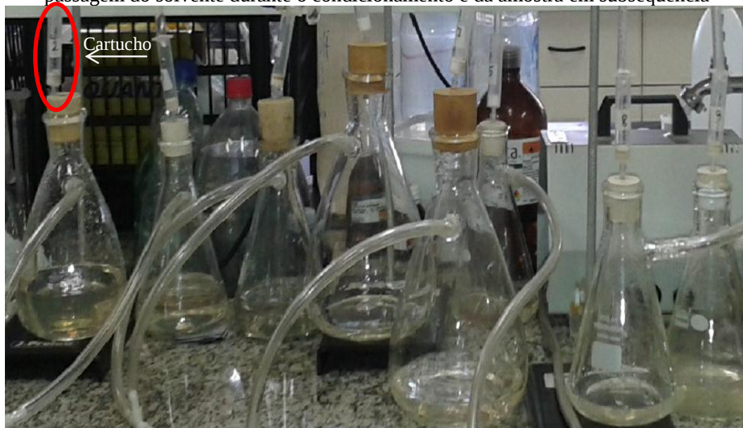
Figura 5.8 – Indicação dos cartuchos utilizados bem como do aparato estruturado para promover a passagem do solvente durante o condicionamento e da amostra em subsequência
