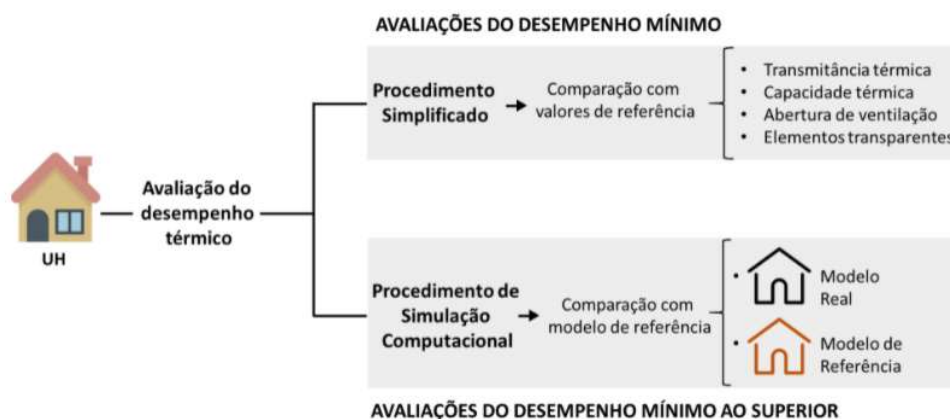
Figura 3.3: Método de avaliação de desempenho térmico da NBR15575-3
