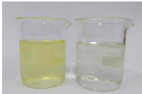
FIGURA 39. Extratos da Re-extração 01. À esquerda, fase orgânica. À direita, fase aquosa.
