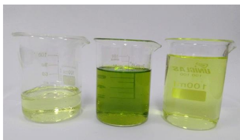
FIGURA 38. Extratos da Extração 01. À esquerda, terceira fase. Centro, fase orgânica. À direita, fase aquosa.
