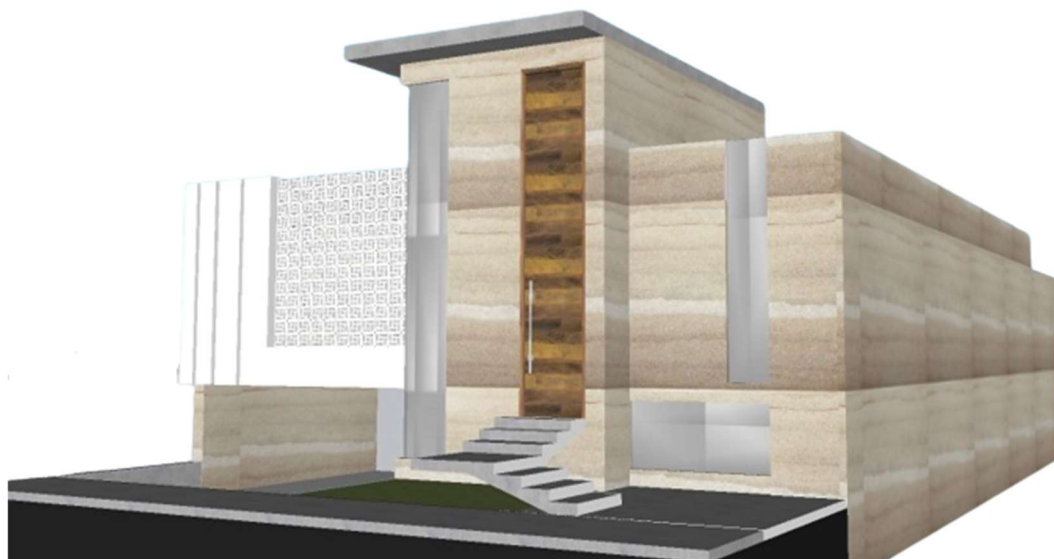
Figura 15- maquete 3D - Casa taipa de pilão solo cimento (estudo de caso)
