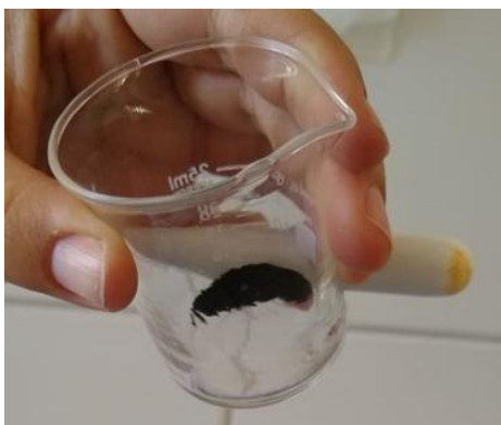
Figura 30: Teste qualitativo da magnetização do \text{CoFe}_2\text{O}_4
