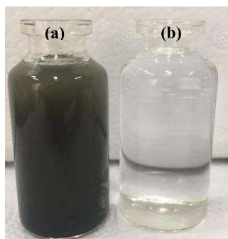
Figura 13. (a) Efluente bruto (esgoto) e (b) efluente após a coagulação com \text{FeCl}_3 (200 mg/L) em pH 7,0.
