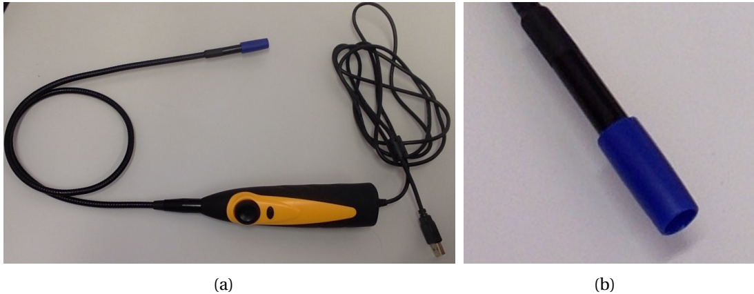
Figura 10 – (a) Câmera endoscópica; (b) Ajuste mecânico.
