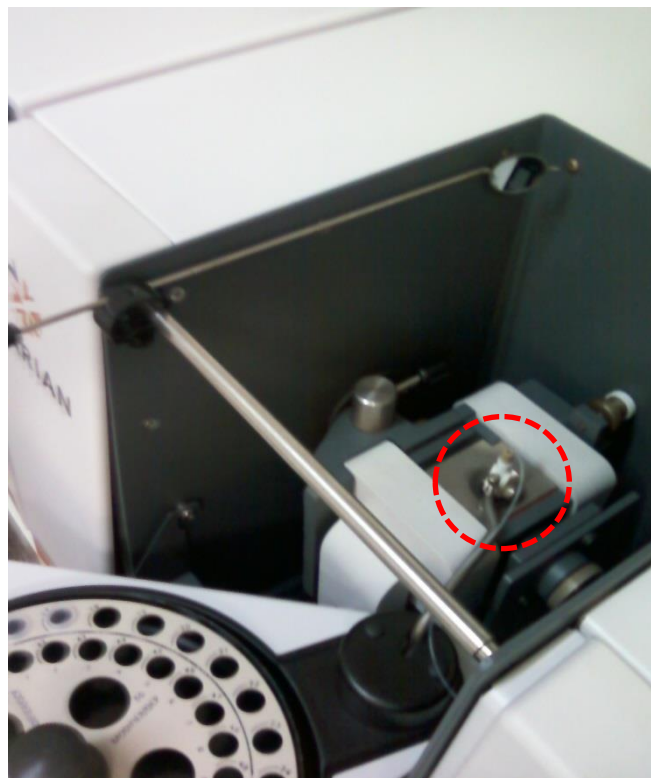
FIGURA 4.4 Injeção da amostra no atomizador eletrotérmico do forno de grafite (Laboratório de Espectroscopia Aplicada – LEA, IQ-UFU).
