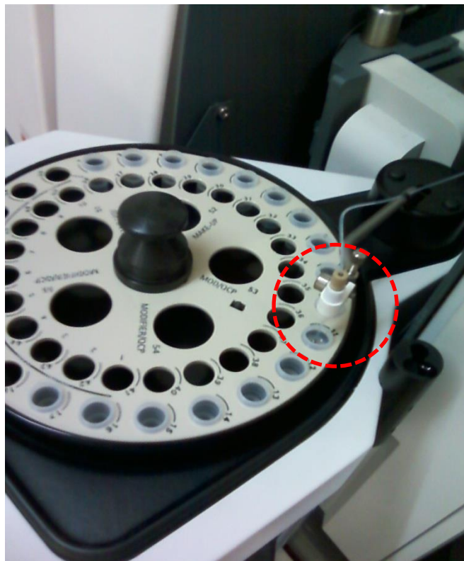
FIGURA 4.3 Pipetador automático do equipamento GF AAS recolhendo a amostra presente nos “vials” do auto-amostrador (Laboratório de Espectroscopia Aplicada – LEA, IQ-UFU).
