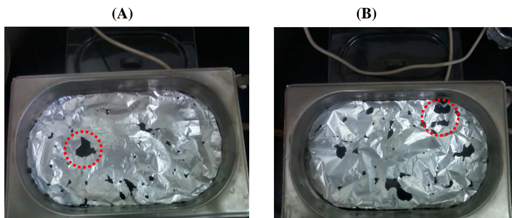
FIGURA 5.17 Focalização do posicionamento das amostras nos banhos de ultra-som por meio do teste do papel alumínio.
