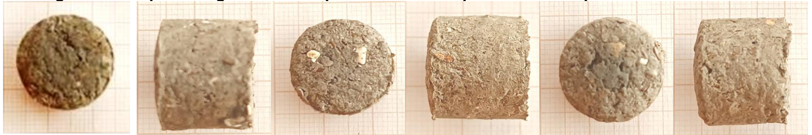
Figura 20. Briquetes organominerais produzidos na etapa 2. Fonte: Própria.
