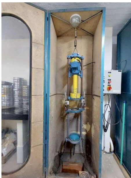
Figura 14 – Peneirador suspenso empregado nos testes.
