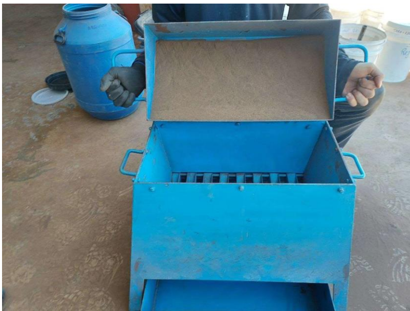
Figura 13 – Quarteamento e homogeneização em quarteador Jones.
