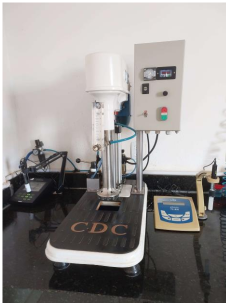
Figura 15 – Célula de flotação de bancada modelo Denver CDC.
