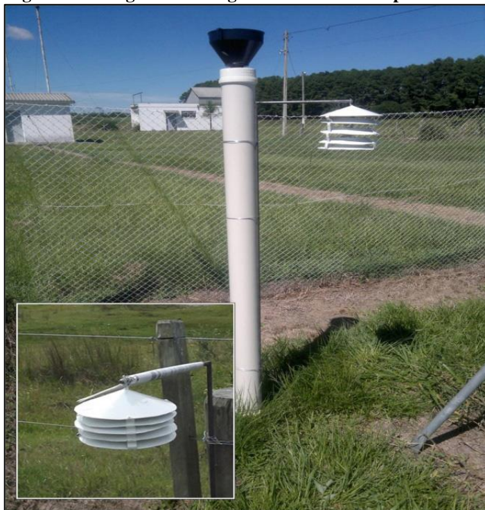
Figura 7 - Abrigo meteorológico de baixo custo e pluviômetro
