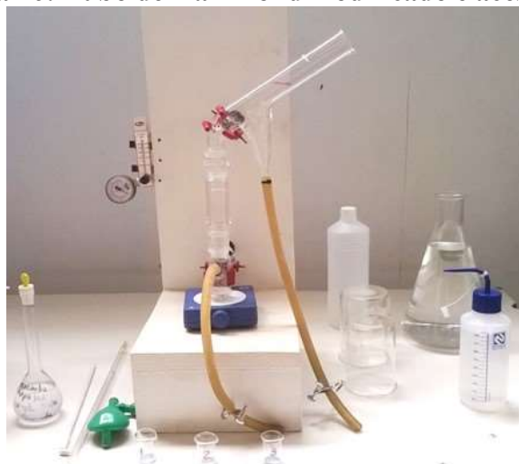
Figura 16: Tubo de Hallimond modificado e acessórios.
