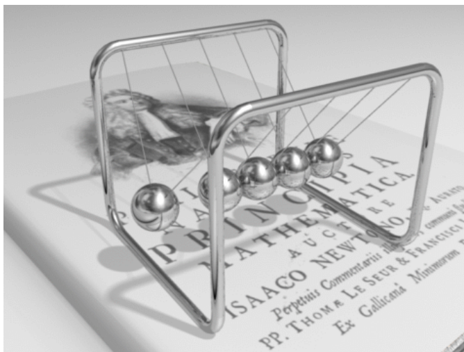
Figura 3.60 – O pêndulo de Newton e a conservação do momentum linear.
