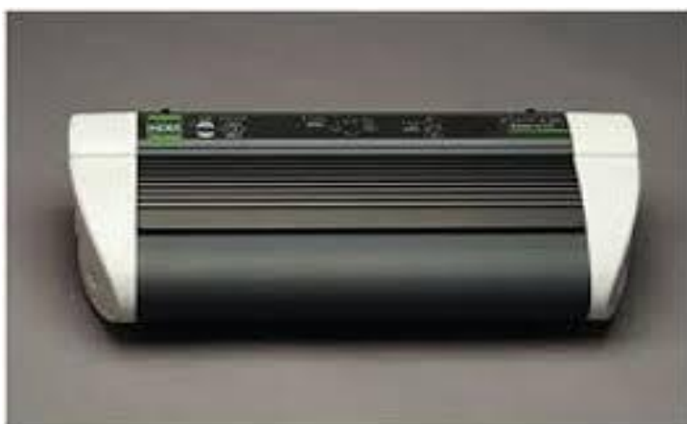
Figura 5 – Imagem da Impressora Braille, dispositivo para imprimir em Braille (retirada de http://www.digitalbegotto.com.br/lojavirtual ).
