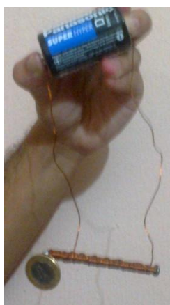
Figura 29 - Eletroímã horizontal. Nota-se que este não possui interruptor, tendo que ser conectado às pilhas manualmente.
