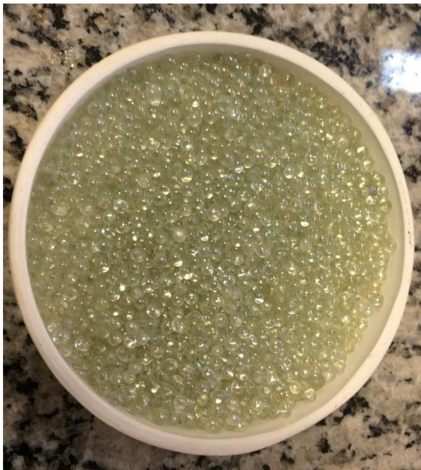
FIGURA 27. Filmes Finos de \text{TiO}_2 depositados com auxílio do pincel.
