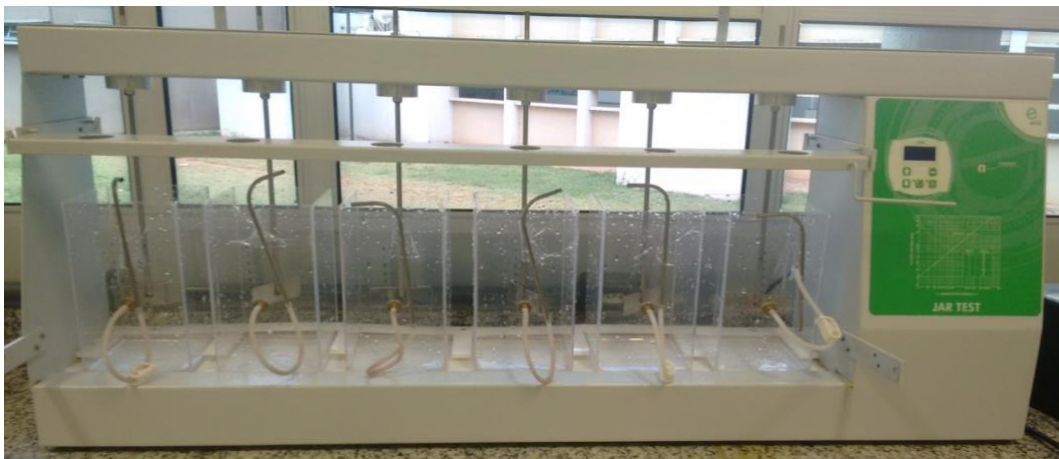
Figura 2: Equipamento Jar test utilizado para a etapa de coagulação
