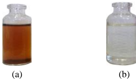
Figura 11: Fotografias do lixiviado após o tratamento por (a) coagulação química (dosagem de sulfato de alumínio = 20 mL/L e pH 6,0) e (b) eletrólise (50 mA/cm 2 por 90 min seguido por 25 mA/cm 2 por 90 min).
