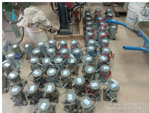
Figura 6.7 – Moldagem dos CPs
