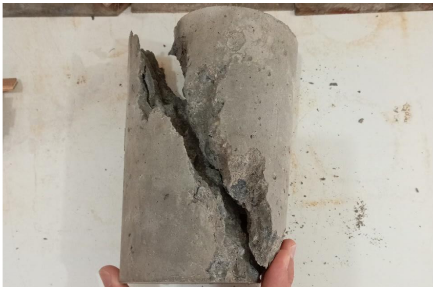
Figura 6.29 – Foto rompimento compressão axial
