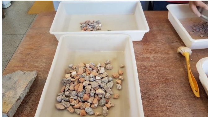
Figura 6.5 – Separação do material peneirado
