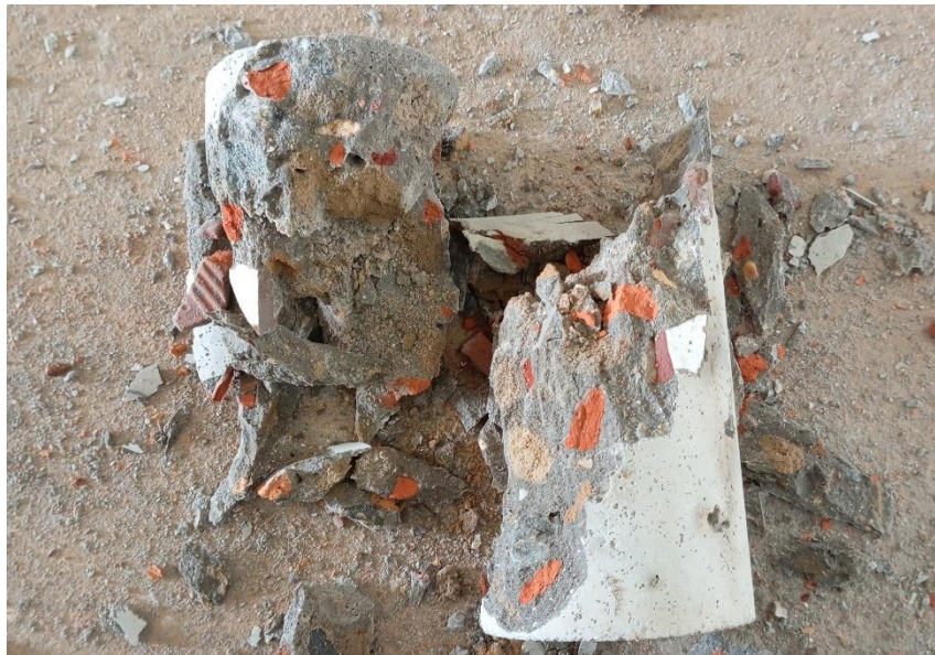
Figura 6.32 – Foto CP rompido compressão axial
