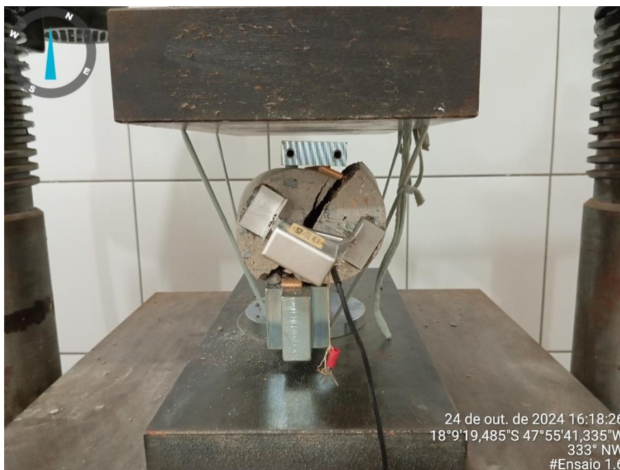
Figura 6.30 – Foto rompimento compressão diametral
