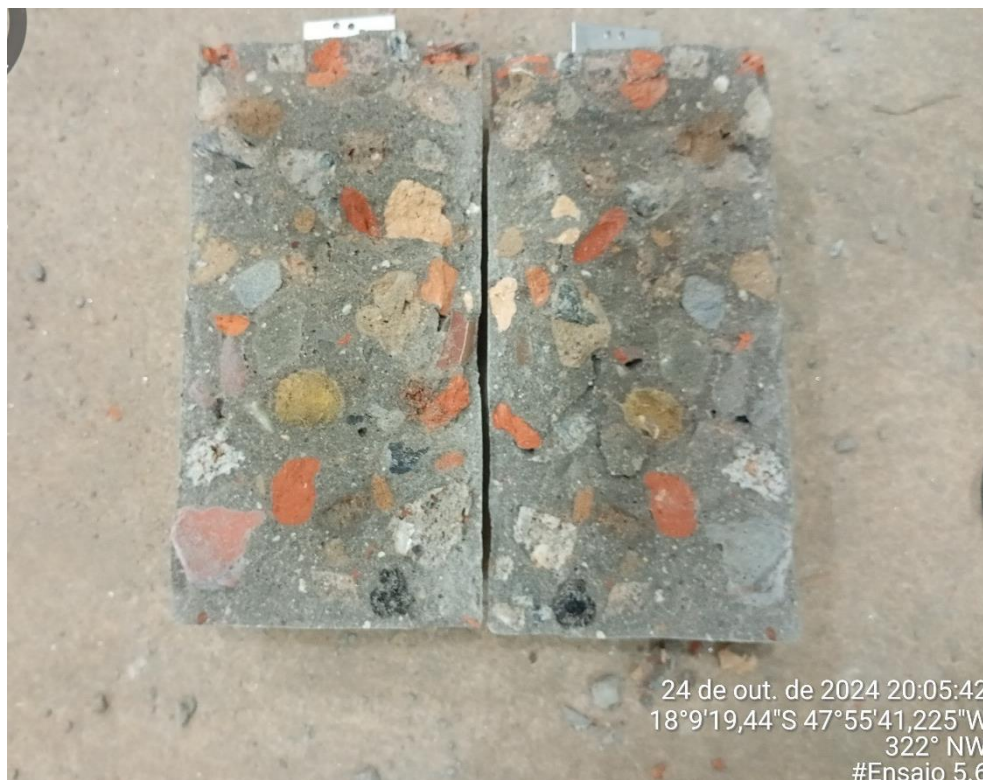
Figura 6.33 – Foto CP rompido compressão diametral
