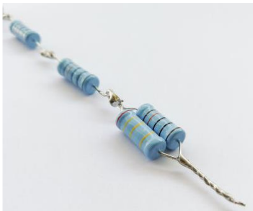
Figura 3.27: Associação Mista de Resistores.
