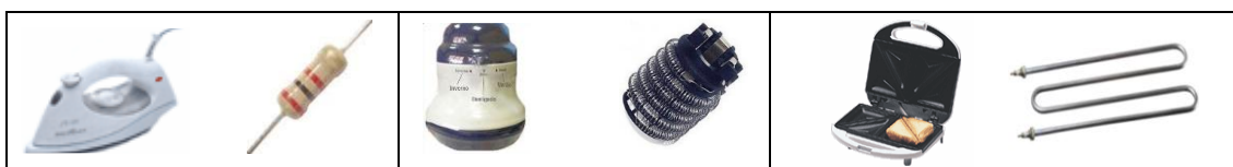
Figura 3.5: Exemplos de aparelhos e seus respectivos resistores.
