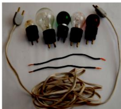
Figura 2 - Lâmpadas, fios e bocais.
