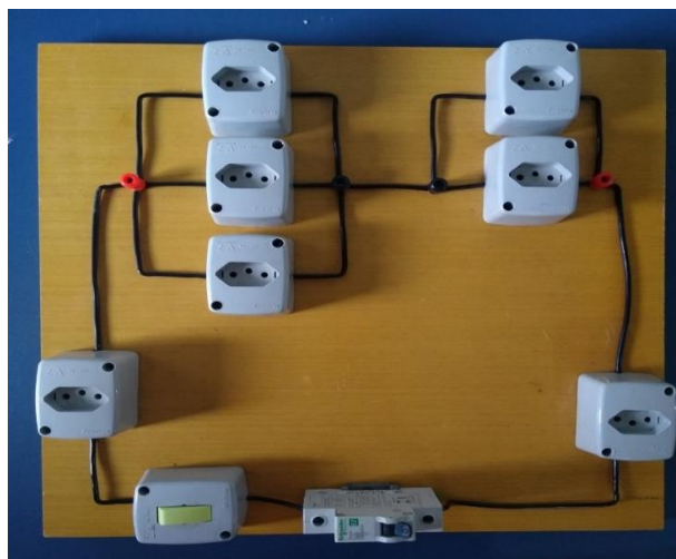
Figura 5.1: Montagem de um circuito elétrico.
