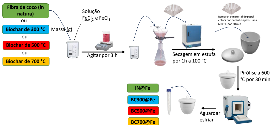
Figura 7- esquema que ilustra a produção dos catalizadores
