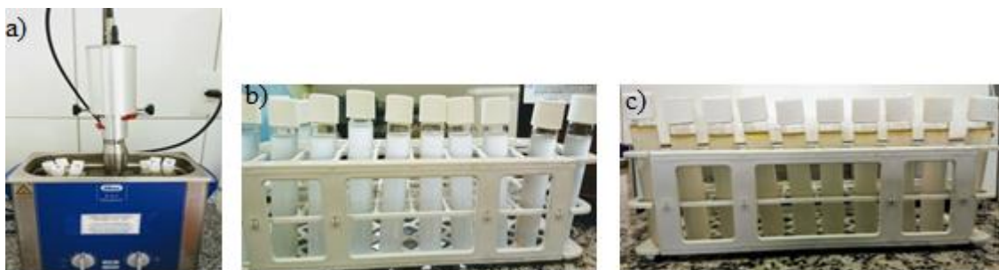
FIGURA 12: Fotos da EPN. a) Amostras no banho termostático; b) Após adição de 0,6 g de NaCl e c) Amostras após separação de fases. Fonte: Autora.
