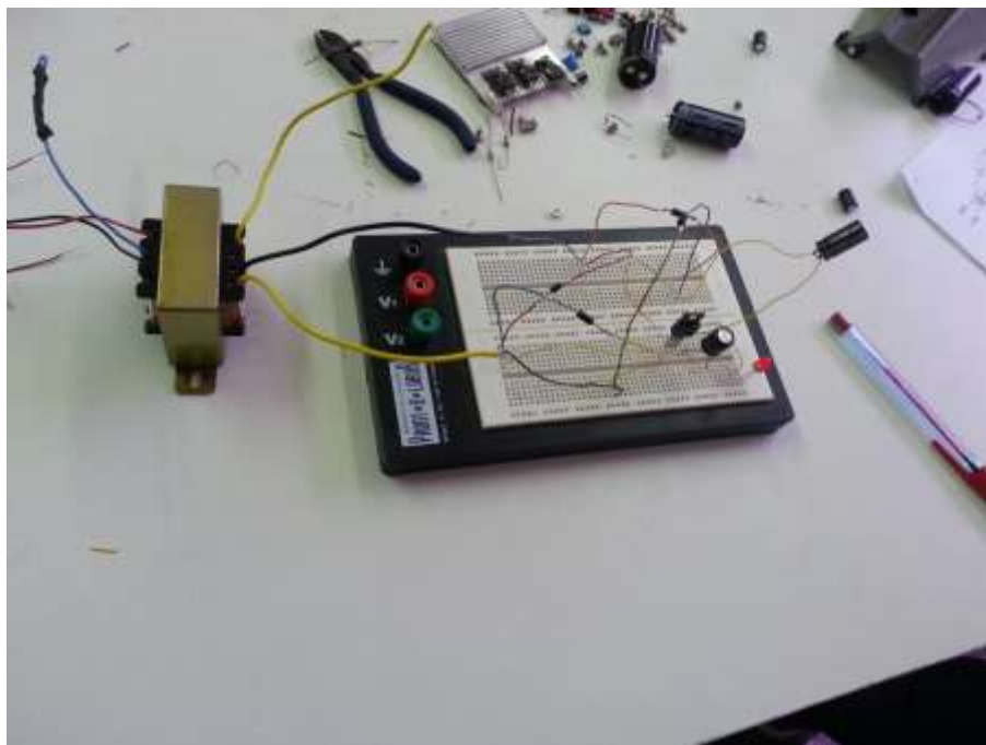
Figura 2.24 – Circuito da fonte DC montado em um protoboard.
