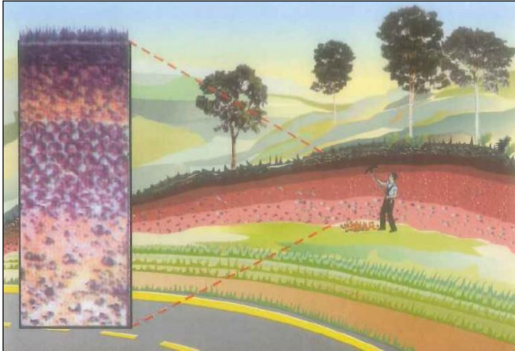
Figura 17 - Taludes de estradas, expondo o perfil do solo.
