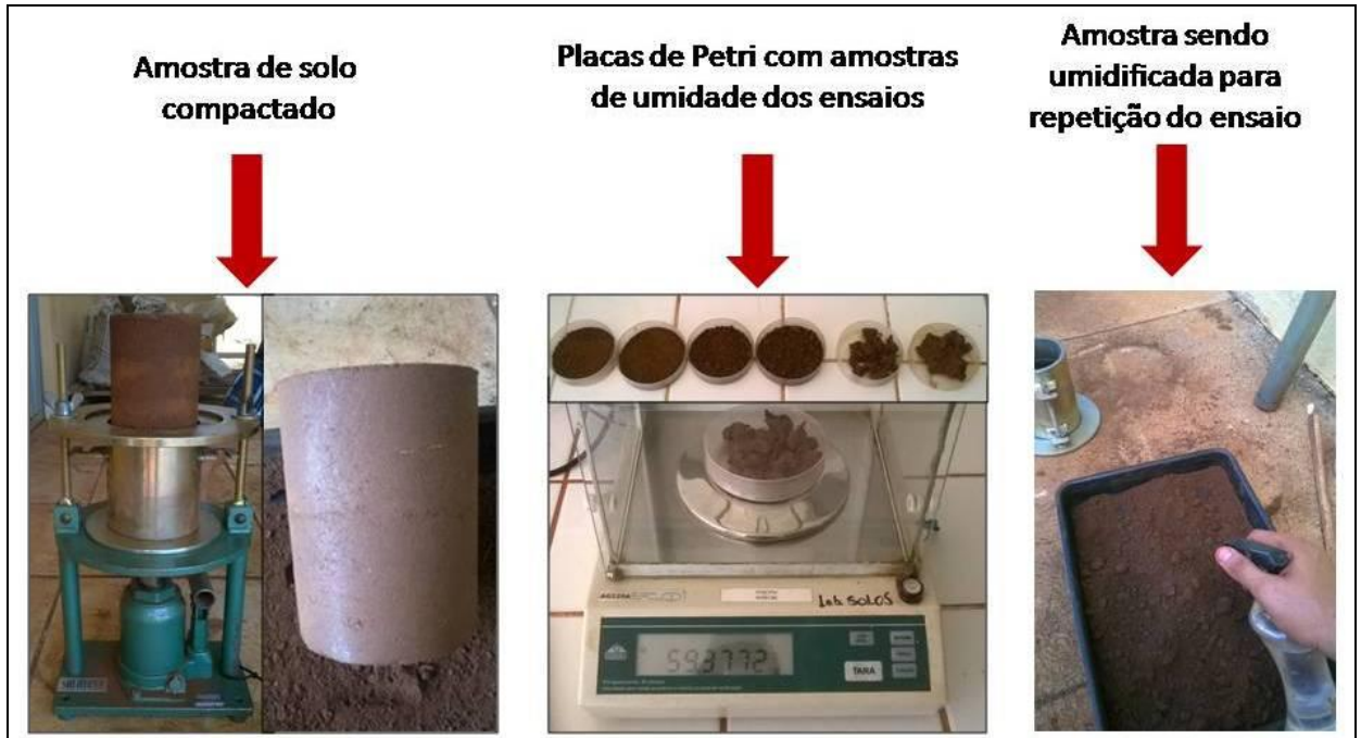
Figura 12 - Etapas do ensaio de compactação pelo cilindro de Proctor
