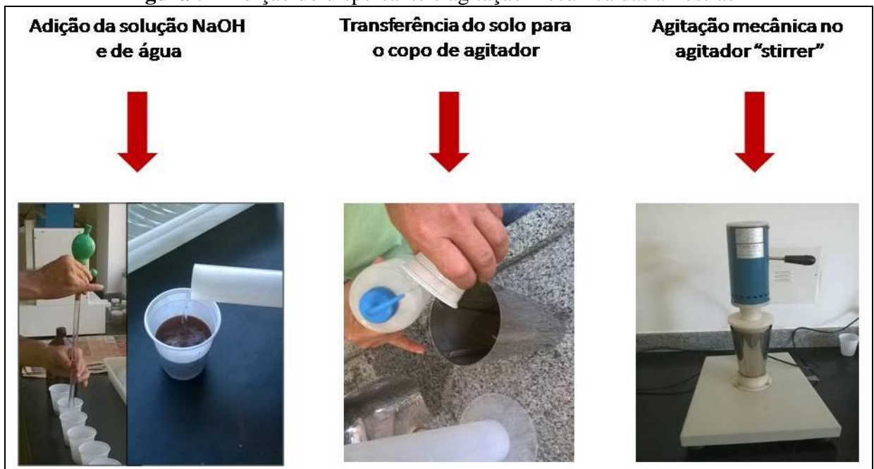
Figura 5 - Adição do dispersante e agitação mecânica das amostras
