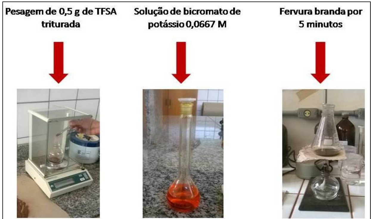
Figura 14 - Etapas iniciais do ensaio de matéria orgânica do solo
