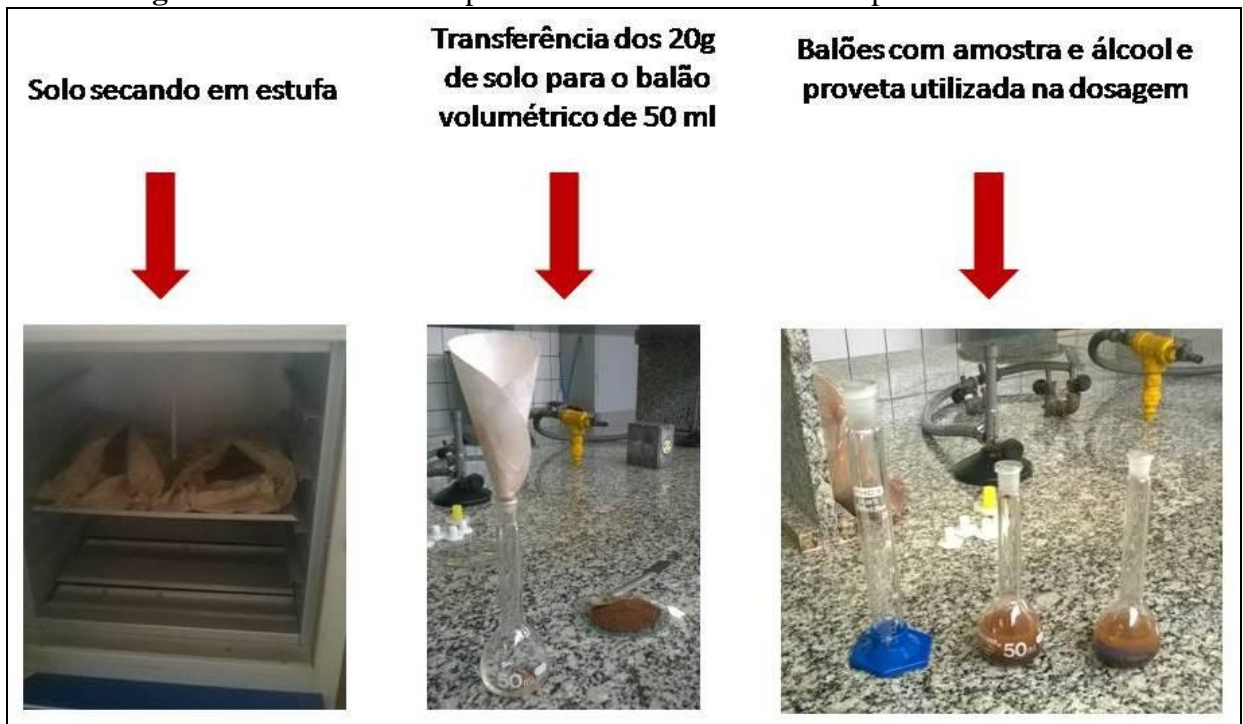
Figura 9 - Procedimentos para determinar a densidade de partículas do solo
