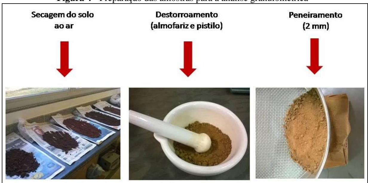
Figura 4 - Preparação das amostras para a análise granulométrica
