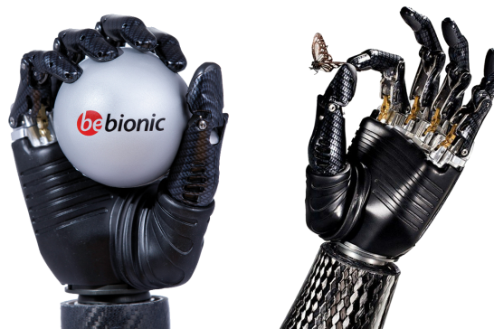
Figura 1.5 – Exemplo de protóteses biônicas, na esquerda o modelo Michelangelo da empresa Ottobock, na direita o modelo i-limb da empresa Touch Bionics.
