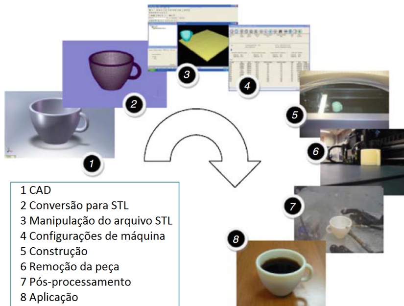
Figura 3.2 – Passos do processo de criação e confecção por FDM.
