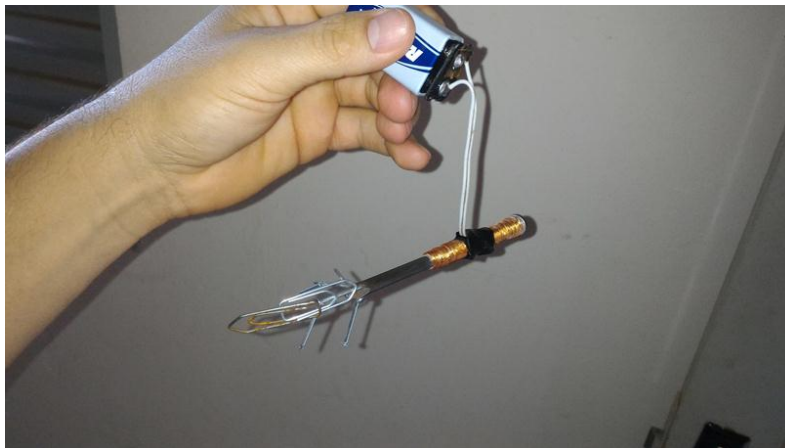
Figura 2.5 - Eletroímã em funcionamento.
